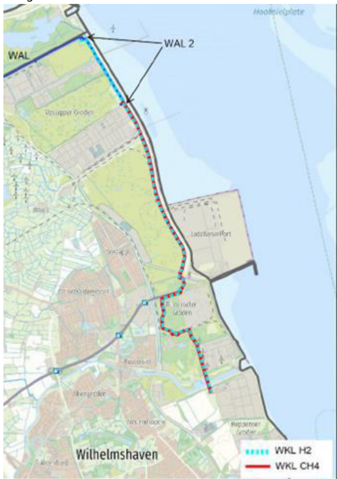
Abbildung 17: Geplante WAL2-Trasse und WKL-Trasse
