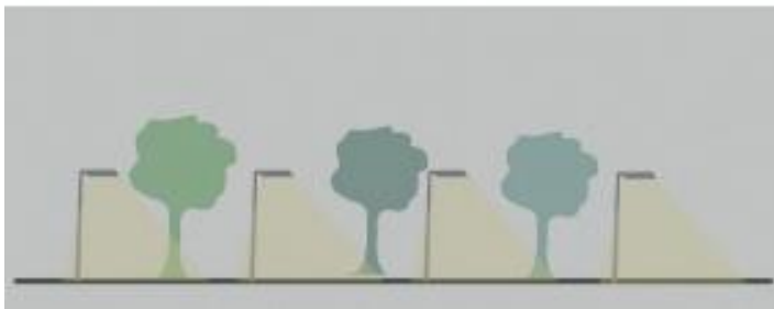
Kombinierte Wirkung von abgeschirmten Leuchten und kurzen Masten
